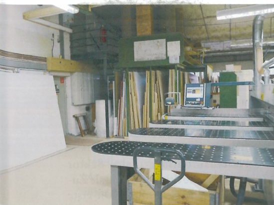
Die Platten lagern senkrecht – wie in den meisten Tischlereien, weil sie so am wenigsten Platz beanspruchen, aber am leichtesten manuell zu handhaben sind.
