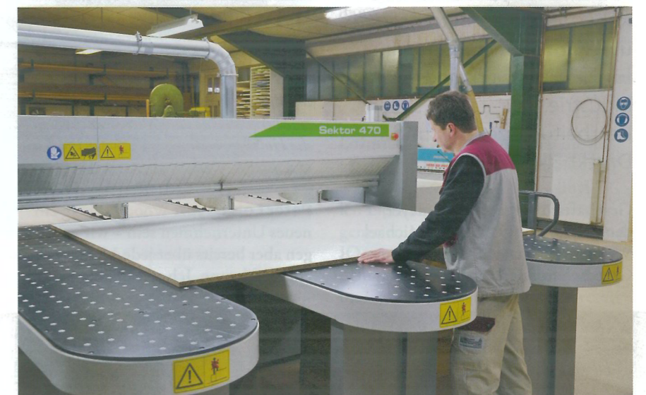
Wenn die Platte auf dem Aufgabebereich der CNC-gesteuerten Selco-Säge liegt, sorgen über 1000 Luftdüsen für ein reibungsloses Verschieben aller Plattenmaterialien. Nach dem Anlegen an die Schiebe- und Spannelemente beginnt die Arbeit der Säge mit dem Besäumschnitt.
