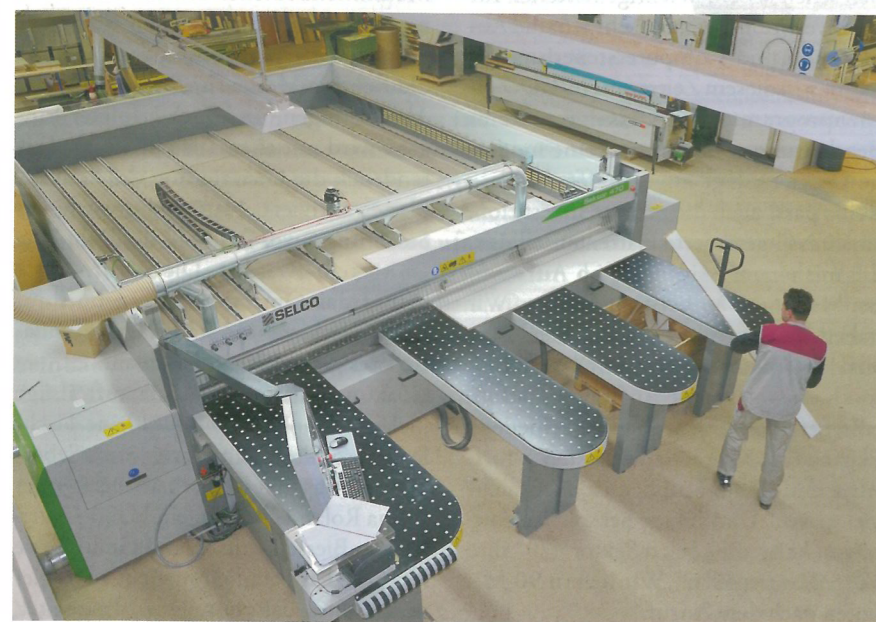
Der Blick von oben auf die Plattenaufteilsäge „Selco Sektor 470“ zeigt ihren Platz bei der Tischlerei Pierenkemper: im Zentrum der Fertigung, in der Mitte des Maschinensaals.
