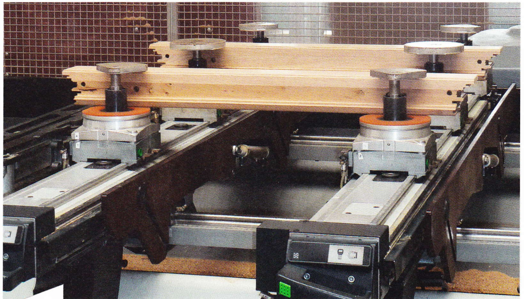
Die Fensterkanten und Leisten werden kommissionsbezogen von der SCM-CNC-Anlage gehobelt; die Maschine stellt sich per Knopfdruck auf das neue Profil ein.
